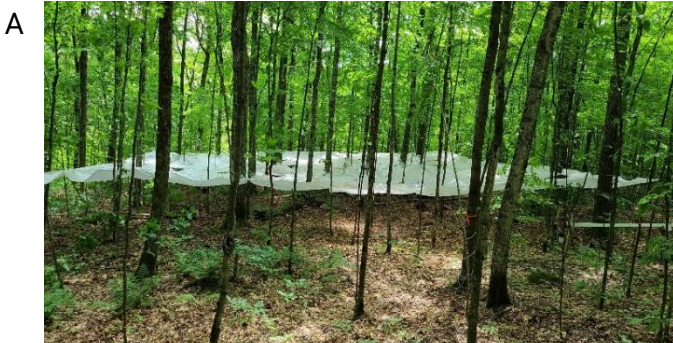
Figure 6. A) photo du dispositif d'exclusion des précipitations. B) Dispositif expérimental des sites de suivi avec et sans prolifération du hêtre et avec et sans exclusion des précipitations.
