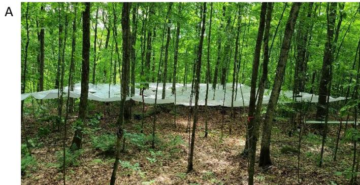
Figure 6. A) photo du dispositif d'exclusion des précipitations.
